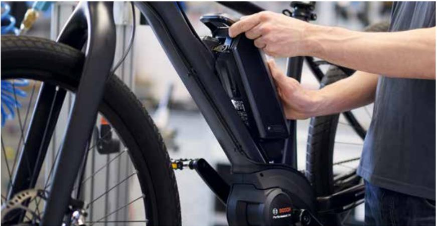
**PowerTube** – Avec la fonction confort, lors du déverrouillage, le PowerTube se déplace sur environ deux centimètres pour une préhension intuitive. Un mécanisme de sécurité empêche par ailleurs la chute de la batterie, qui est également protégée par le cadre.
