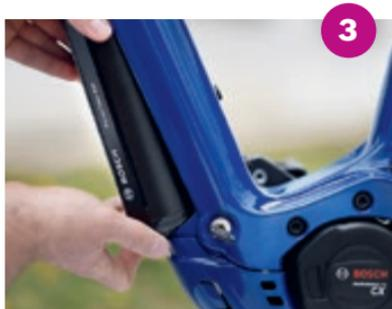
Dégager la batterie de la protection de retenue par une pression sur la partie supérieure – la batterie peut être saisie
